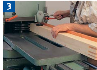
Handvorschub = Arbeiten mit dem Schiebeshlitten
