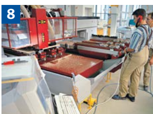
Mechanischer Vorschub = z. B. Arbeiten mit CNC Bearbeitungszentrum
