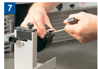
Lösen der Spannschrauben mit vorgegebenem Werkzeug (Imbusschlüssel)
