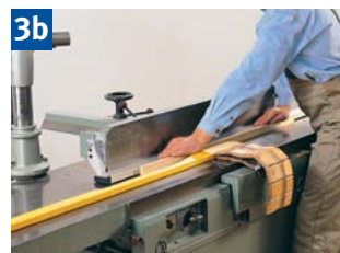
3b Abrichten und Fügen schmaler Werkstücke mit Flügeleiste und Hilfsanschlag.
