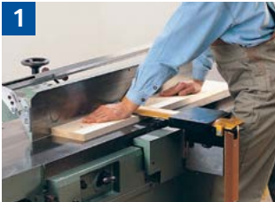
1 Abrichten breiter Werkstücke mit Schutzbrücke.
