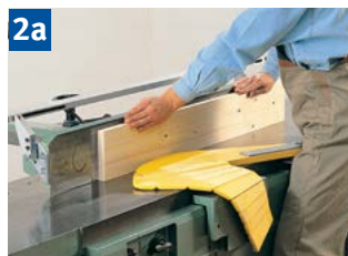
2a Fügen breiter Werkstücke mit Gliederschwingschutz.
