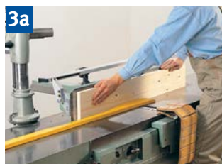
3a Fügen breiter Werkstücke mit Flügeleiste und Klappenschutz.
