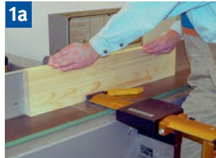
1a Fügen breiter Werkstücke mit Schutzbrücke.
