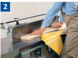
2 Abrichten breiter Werkstücke mit Gliederschwingschutz.
